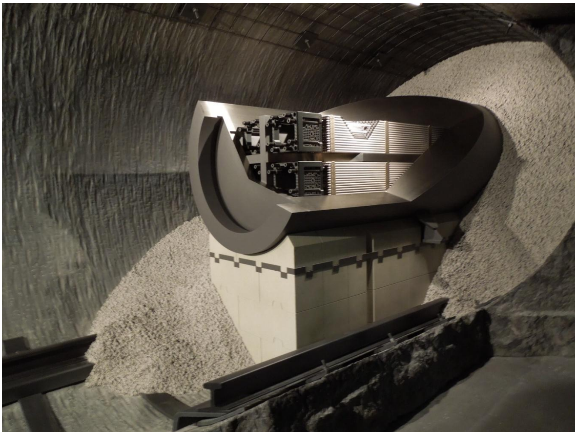
Obr. 7 - Model obalového soubor pro vysoce aktivní odpady – kontejnment v podzemní laboratoři Grimsel [vlastní]
