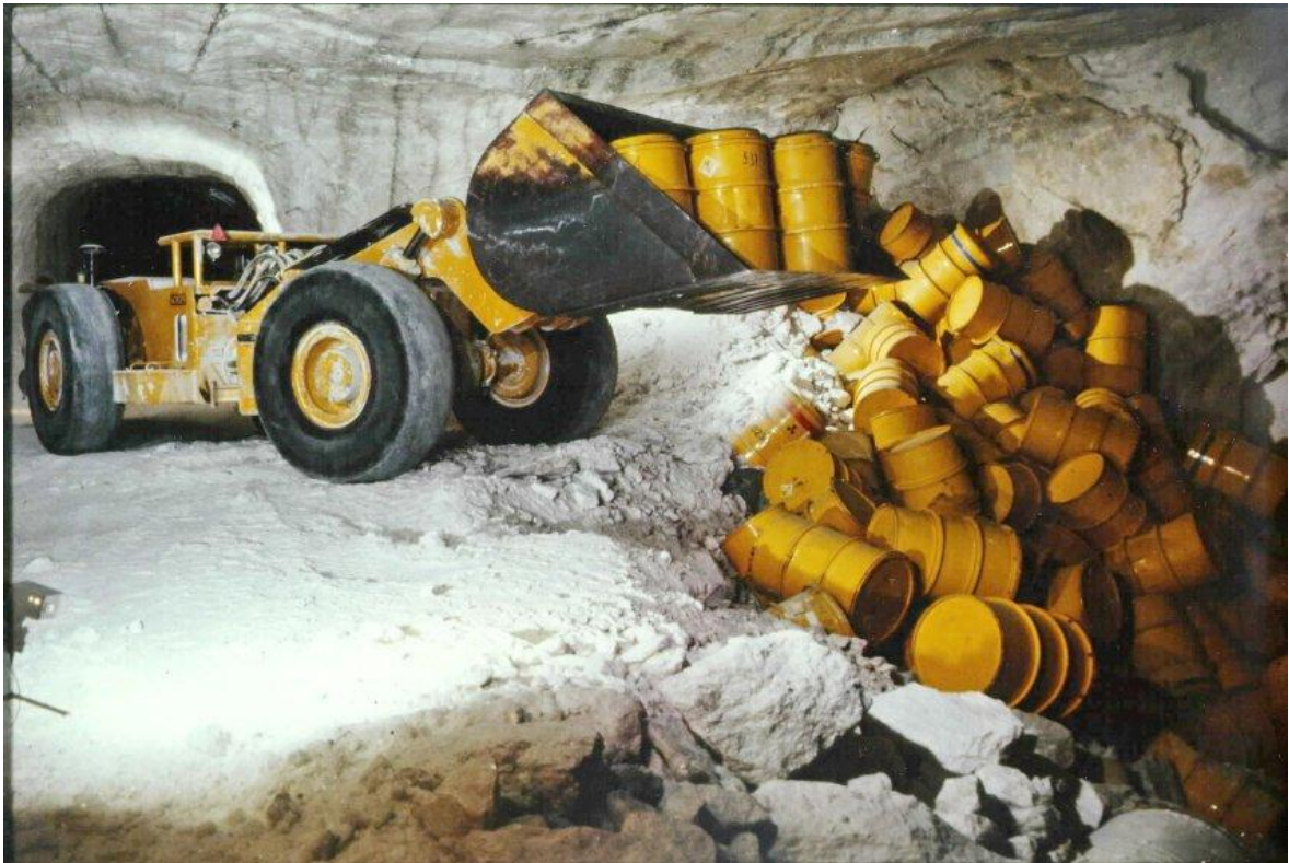
Obr. 5 - Sudy s radioaktivním odpadem v Asse [24]
