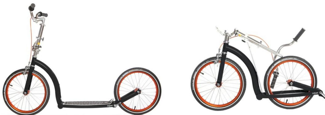
Obrázek 12. Swift One před a po složení (www.mocoloco.com)
