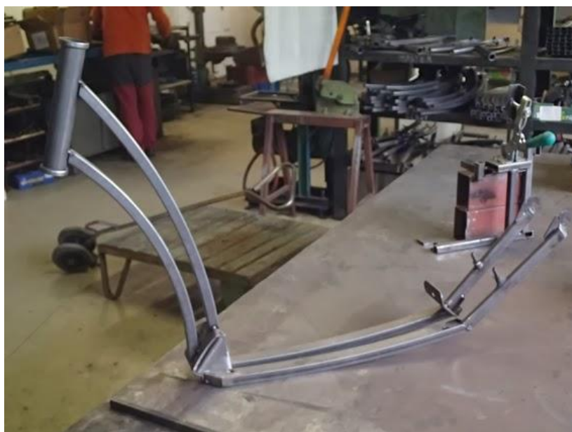
Obrázek 7. Skládací rám koloběžky MIBO Mastr (Classic i Top) ( www.kolobehsport.cz )
