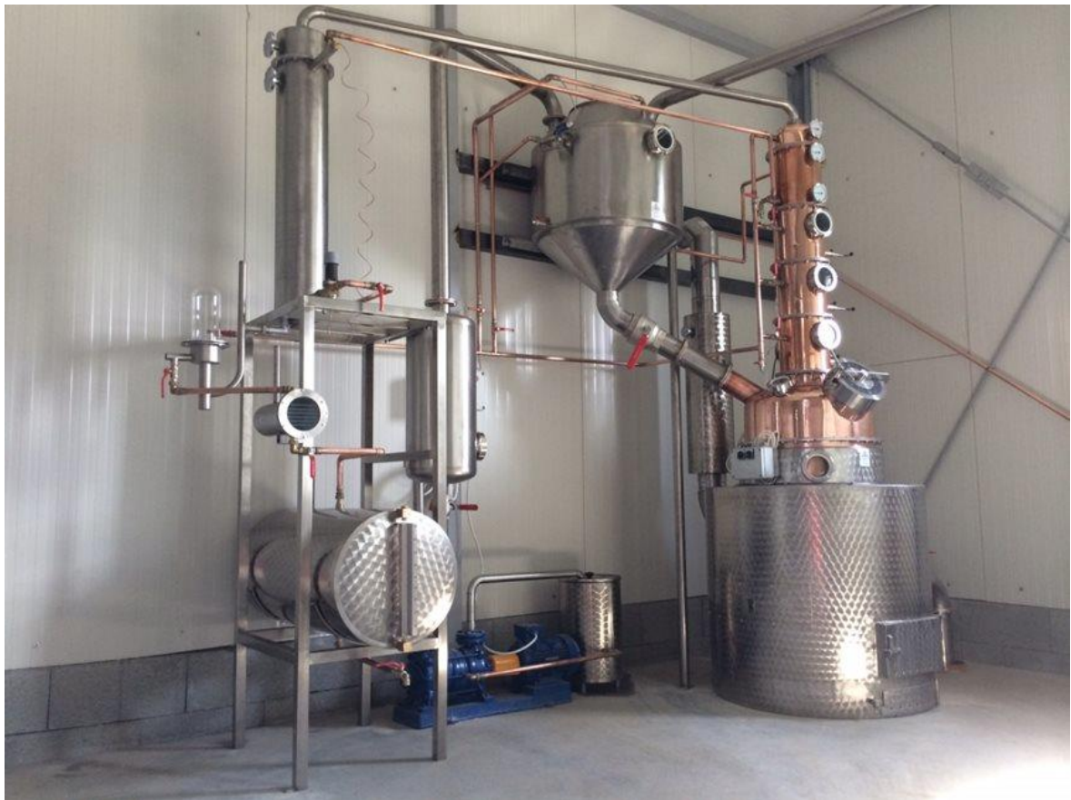
Obr. 4. Ukázka destilačního zařízení s rektifikační kolonou
