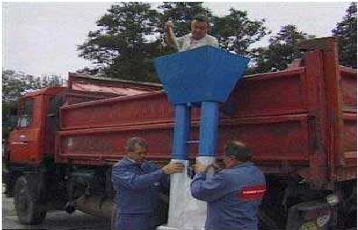
Obrázek 14: Plnění dvoukomorového pytle [13]
