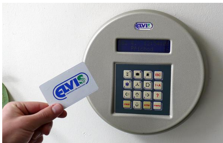
Obrázek 2: Přístupový systém [Zdroj: 15]
