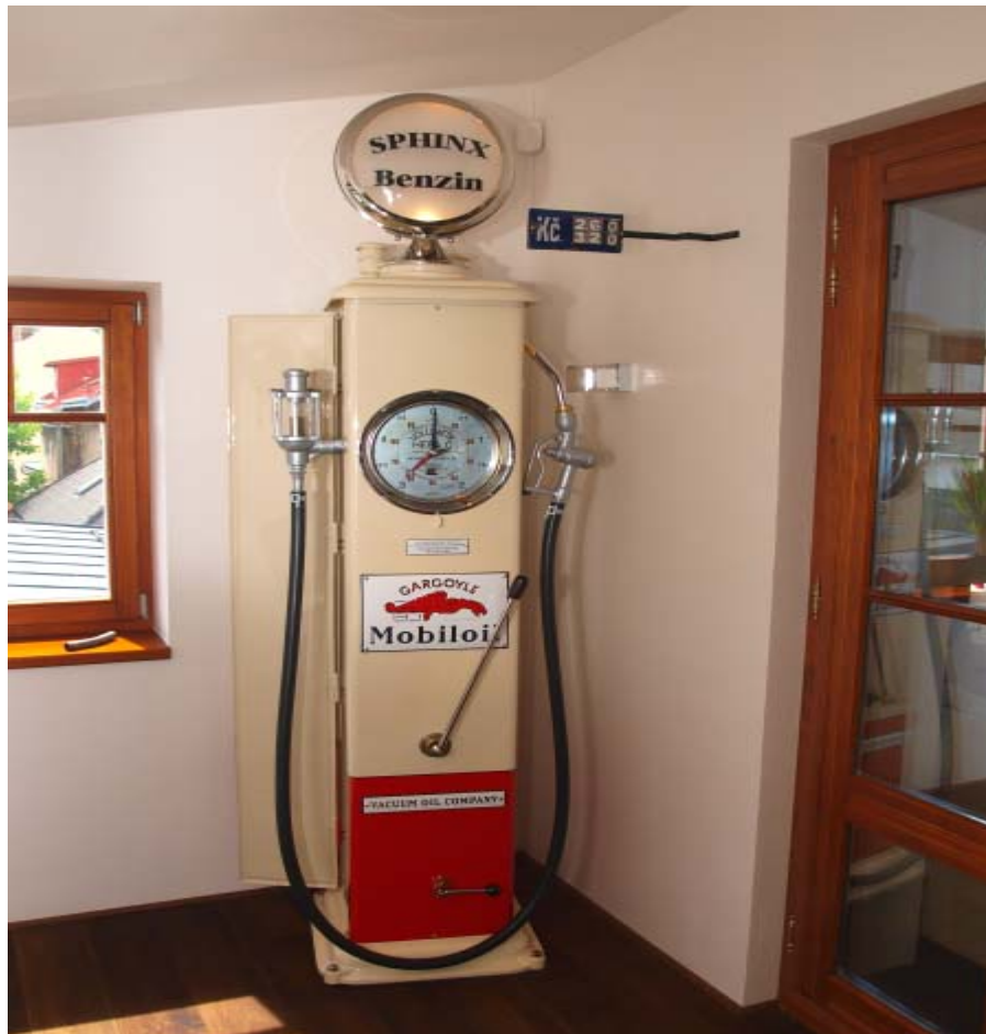
Obrázek č. 1- Unikátní model výdejního stojanu HEFA s prvním průtokovým měřičem ze třicátých let minulého století [25]
