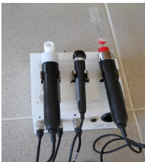
Obr. 7. Stanice MPA5 se sondami (zleva: tewametr, korneometr, pH-metr).
