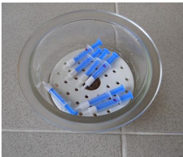
Obr. 9. Injekční stříkačky s jednotlivými krémy uloženy v exsikátoru.
