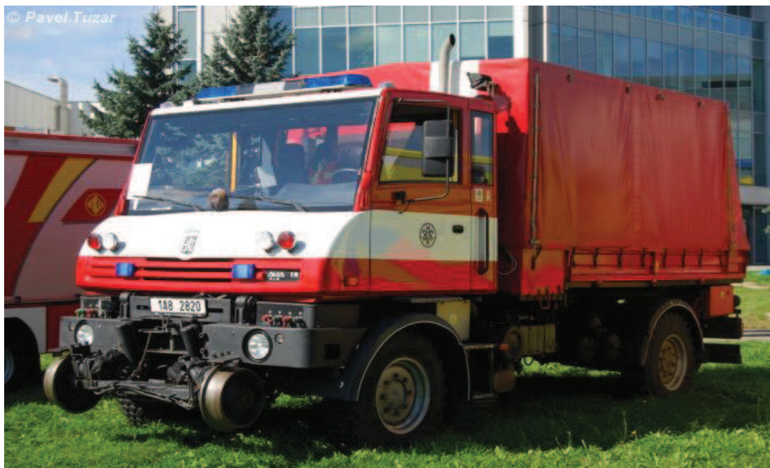
Obr. 8. Dvoucestné zásahové vozidlo Praga, JPO HZS SŽDC Nymburk.[28]
