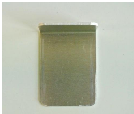
Obr. 23 Příklad hliníkového filtru, pro odstranění měkké části spektra RTG záření.
