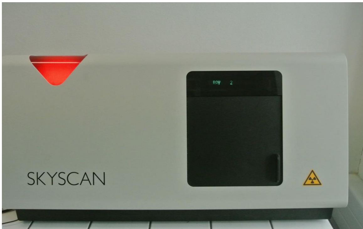
Obr. 18 Použitý rentgenový mikrotomograf od společnosti Bruker, typ 1174.
