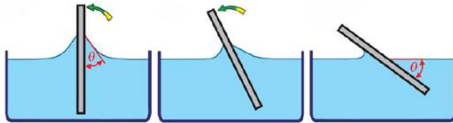
Obr. 16: Měření úhlu smáčení na nakloněné destičce [17]
