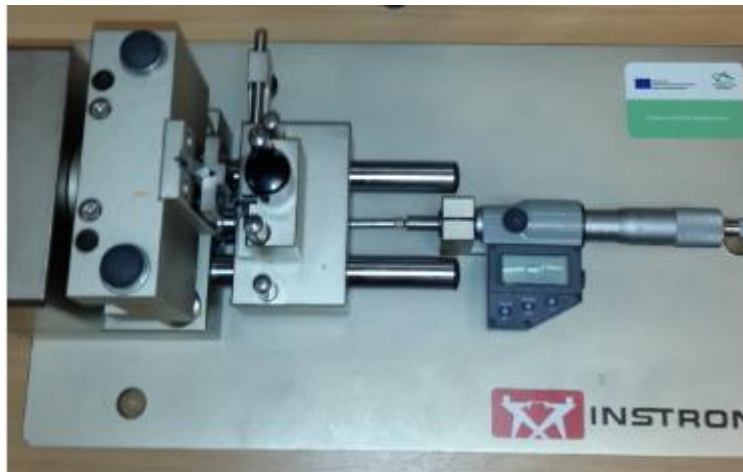
Obrázek 19: Zařízení Instron Notchvis použité pro tvorbu vrubu č. 2
