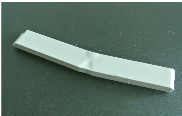
Obrázek 19: zkušební těleso PC/ASA po rázové zkoušce
