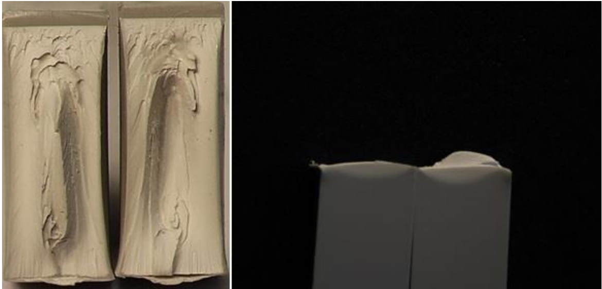
Obrázek 20: Snímky lomových ploch PC/ASA, vrub č. 1
