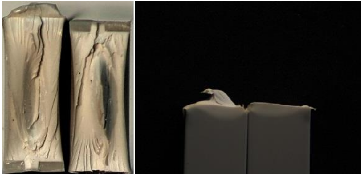
Obrázek 21: Snímky lomových ploch PC/ASA, vrub č. 2
