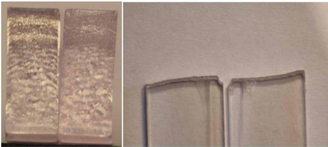
Obrázek 23: Snímky lomových ploch PS, vrub č. 2
