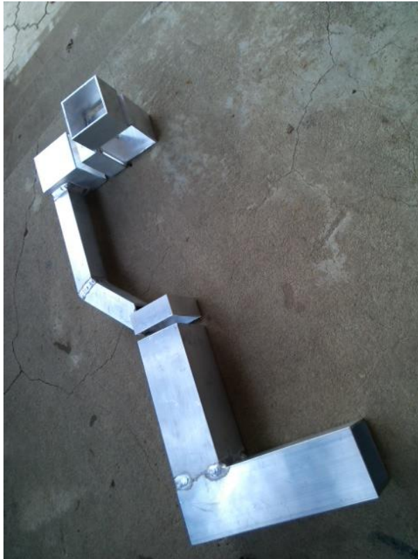
Obr. 32. Reálna ukážka po zváraní konštrukcie [Vlastné spracovanie]
