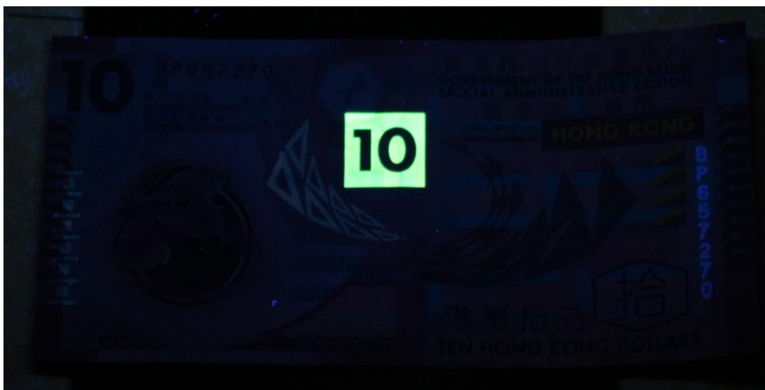
Obrázok 50: Vplyv krátkovlnného UV žiarenia na bankovku 10 HKD
