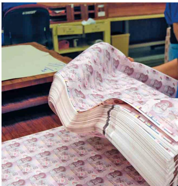
Obrázok 8: Polymérové hárky počas procesu tlače[23]
