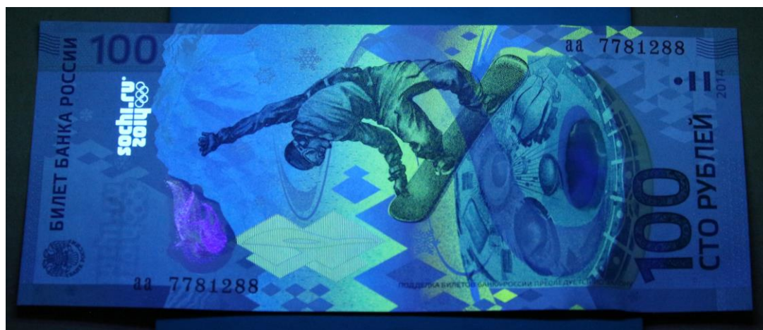
Obrázok 55: Vplyv dlhovlnného UV žiarenia na bankovku 100 RUB
