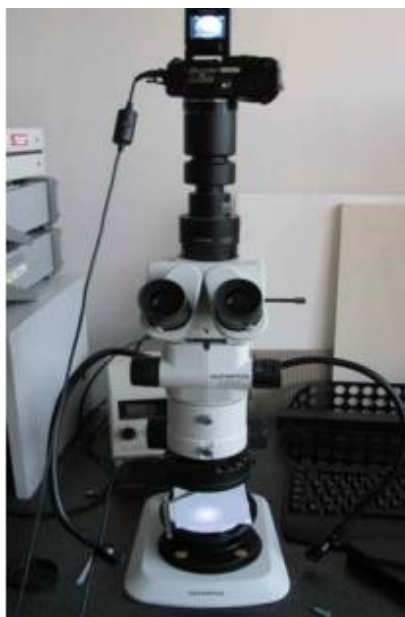
Obrázok 30: Mikroskop Olympus SZX 7 a fotoaparát Olympus C5060WZ
