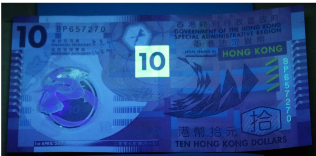
Obrázok 51: Vplyv dlhovlnného UV žiarenia na bankovku 10 HKD
