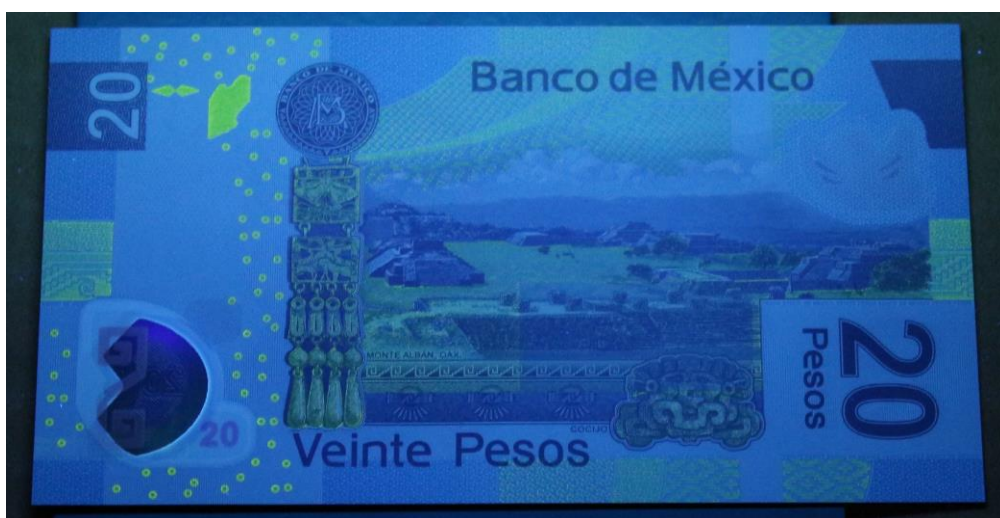
Obrázok 53: Vplyv dlhovlnného UV žiarenia na bankovku 20 MXN
