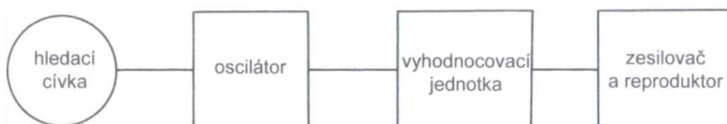
Obrázek 8: Blokové zapojení přístroje na principu změny střídavého pole [5]
