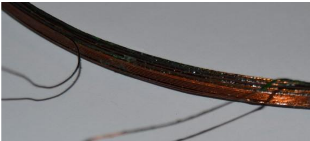
Obrázek 34: Detail navinuté hledací cívky
