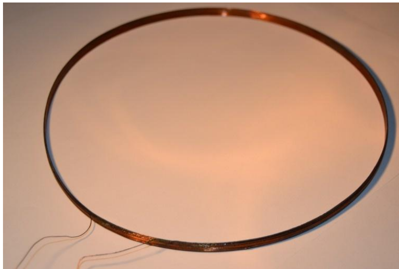
Obrázek 33: Navinutá hledací cívka o průměru 20cm
