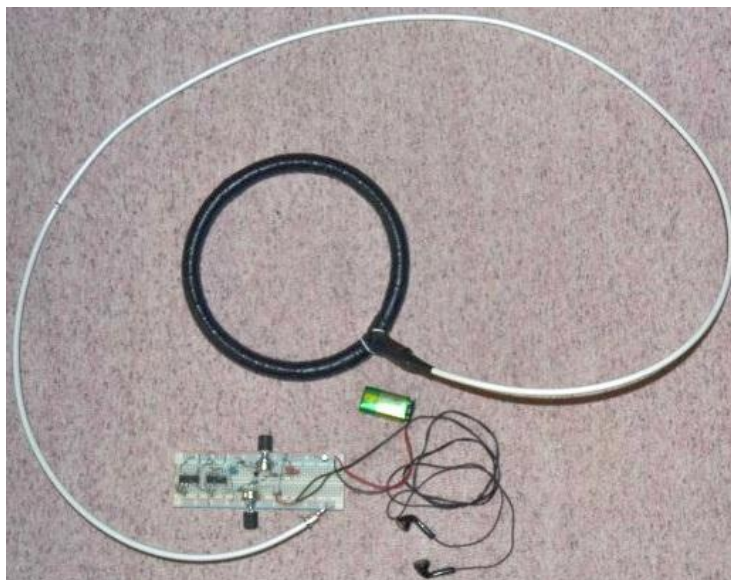
Obrázek 38: Kompletní hledací cívka připojená na kontaktní nepájivé pole
