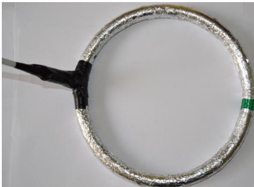
Obrázek 36: Hledací cívka - zafixování koaxiálního kabelu
