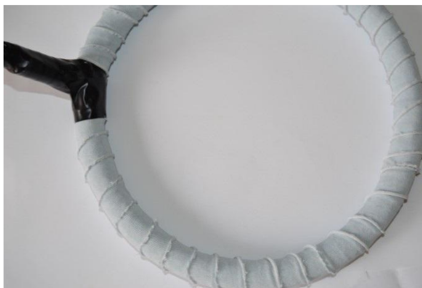
Obrázek 37: Hledací cívka - omotání textilem
