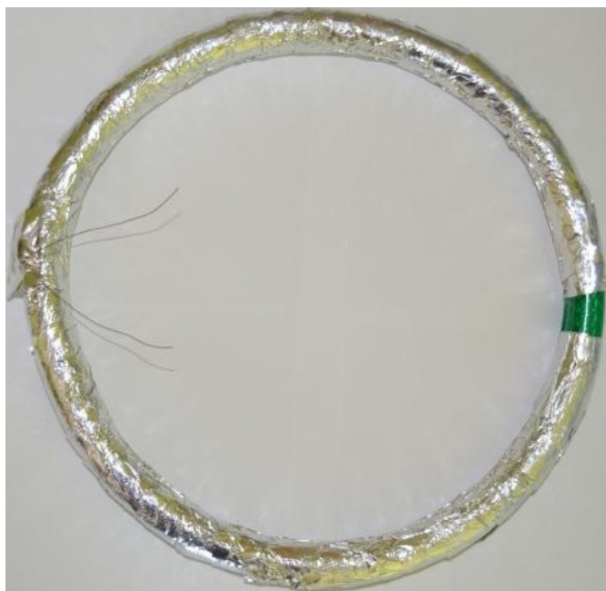
Obrázek 35: Hledací cívka v gumové hadici, olepená proužky alobalu
