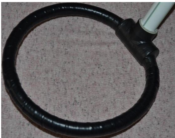
Obrázek 41: Hledací cívka upevněná na plastové trubce
