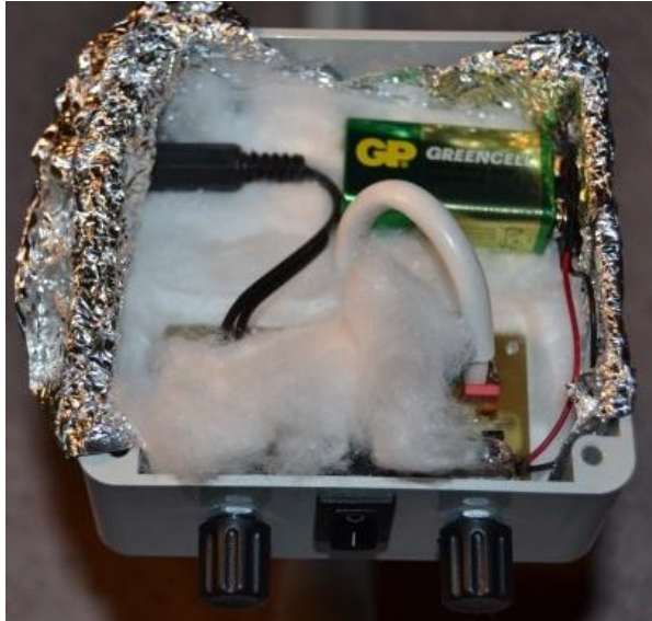
Obrázek 43: DPS osazená v plastové krabici
