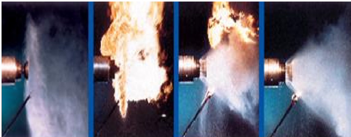
Obr. 6. Aktivace plynového hasicího zařízení
