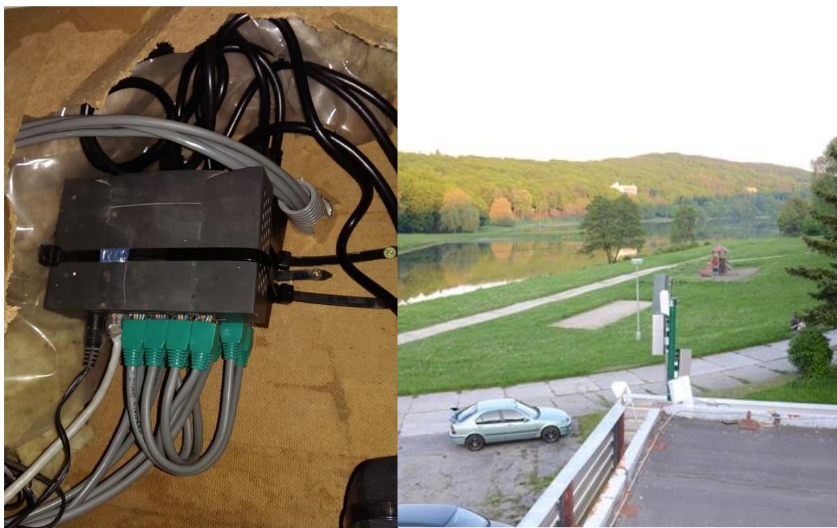
Obrázok 64 – Zapojenie prepínača a Hotspot Dubník 1
