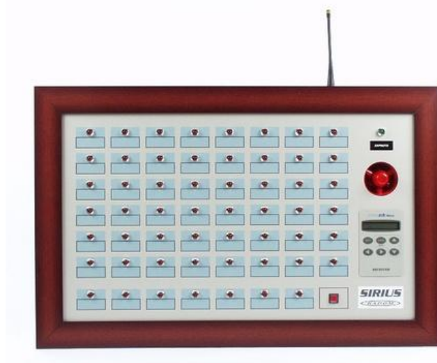
Obrázek 6 Signalizační tabule systému SIRIUS [zdroj obrázku zahrnut v seznamu použité literatury, zdroj číslo 13]
