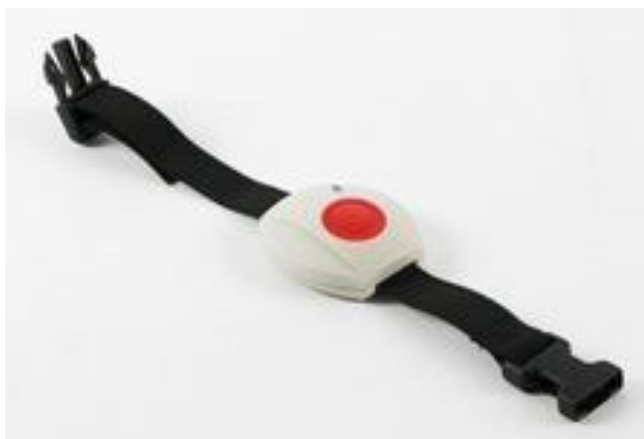
Obrázek 9 Identifikační čip systému ORTHOS [zdroj obrázku zahrnut v seznamu použité literatury, zdroj číslo 16]
