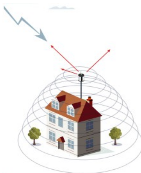
Obr. 36: Posunutí místa úderu blesku nad jímač [19]
