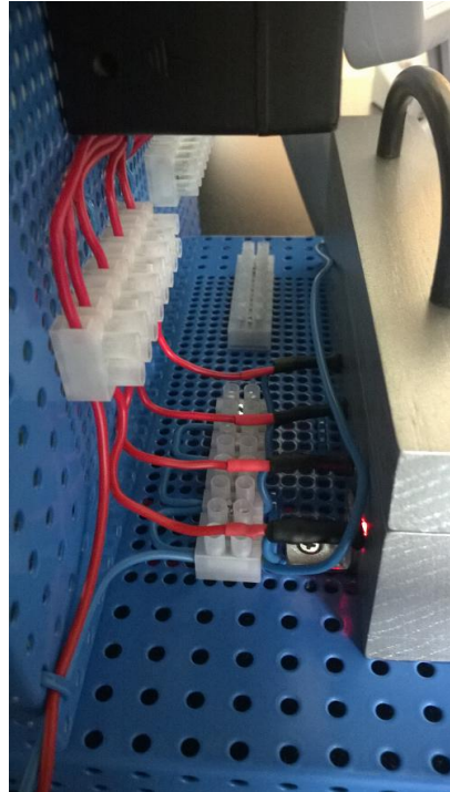
Obr. 36: Zapojení LED ke svorkovnicím
