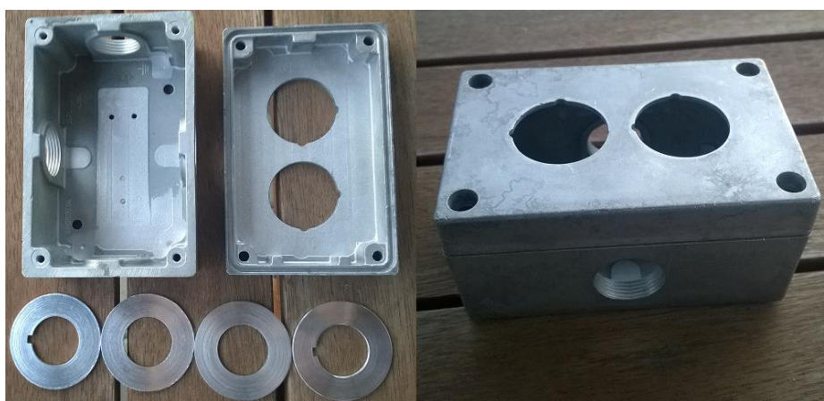
Obr. 31: Upravená krabička pro povrchovou montáž IP 44 T2
