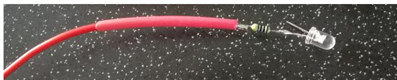
Obr. 34: LED dioda s napájeným předřadným odporem
