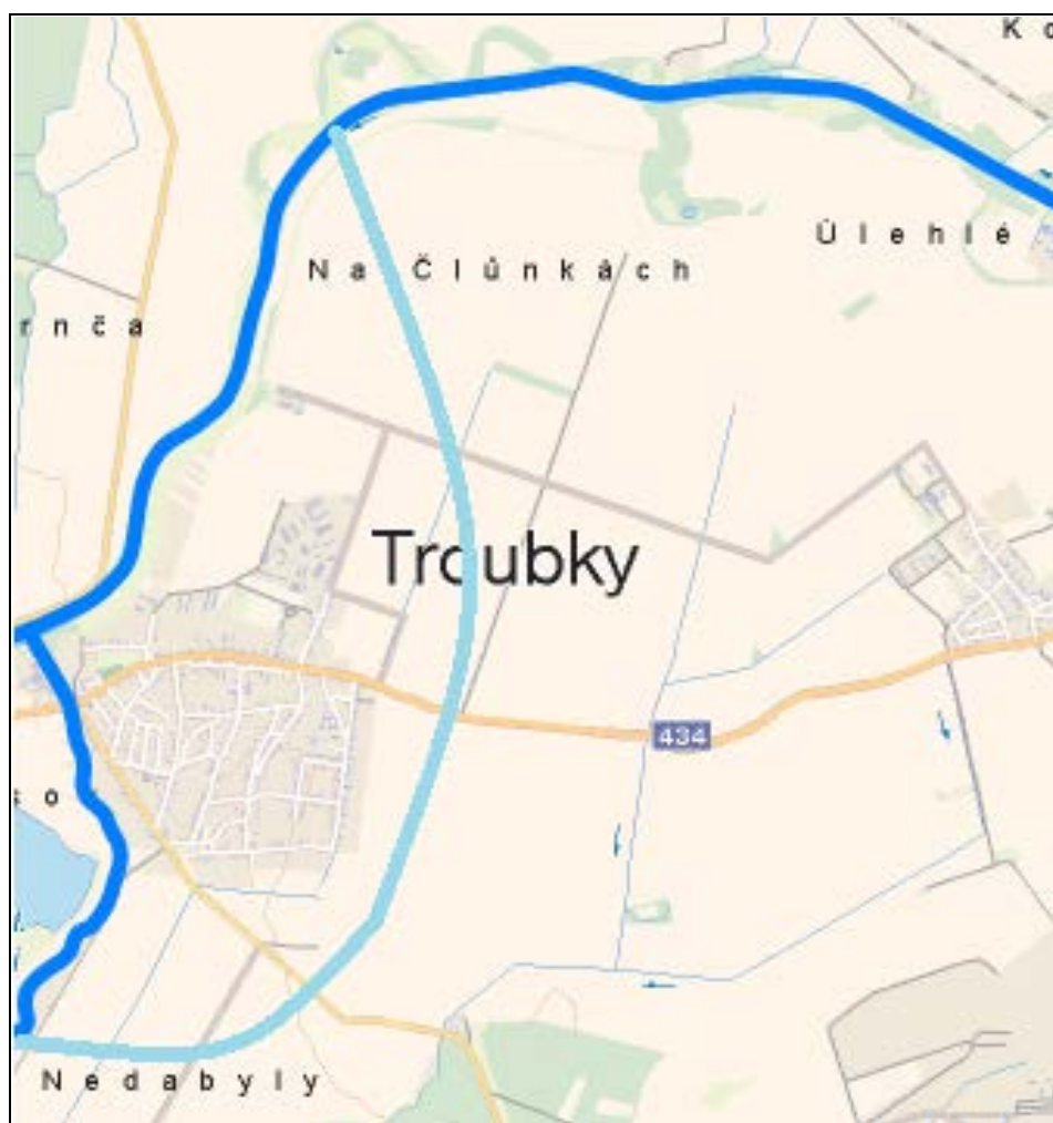
Obr. 17. Návrh obtokového kanálu kolem obce Troubky. Světlejší modrá zde značí obtokový kanál. [13; obtokový kanál: vlastní]
