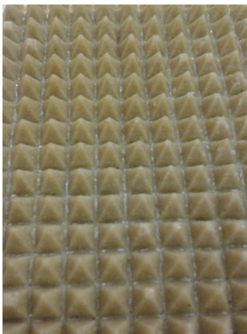
Obr. 61: Detail ozvučnice s pyramidovými výstupky
