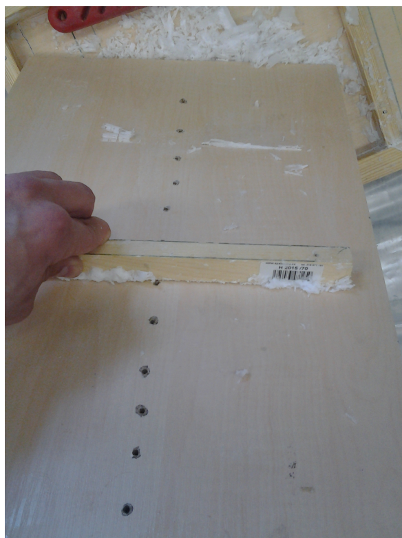
Obr. 58: Odstranění přebytečného parafínu při impregnaci formy
