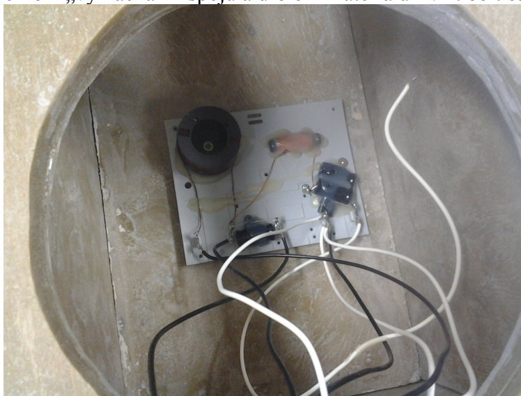
Obr. 63: Osazení reproduktorové skříně výhybkou
