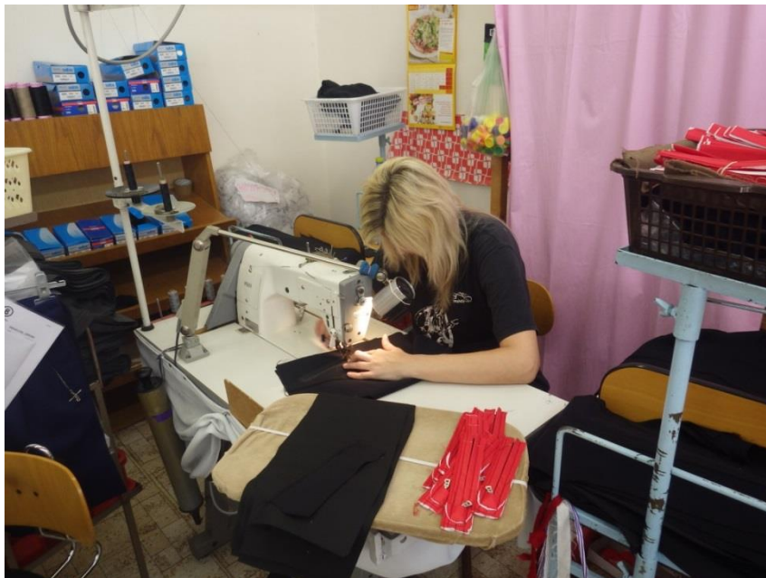
Obrázek 20 Sešívání krokového švu a přišívání zipu
