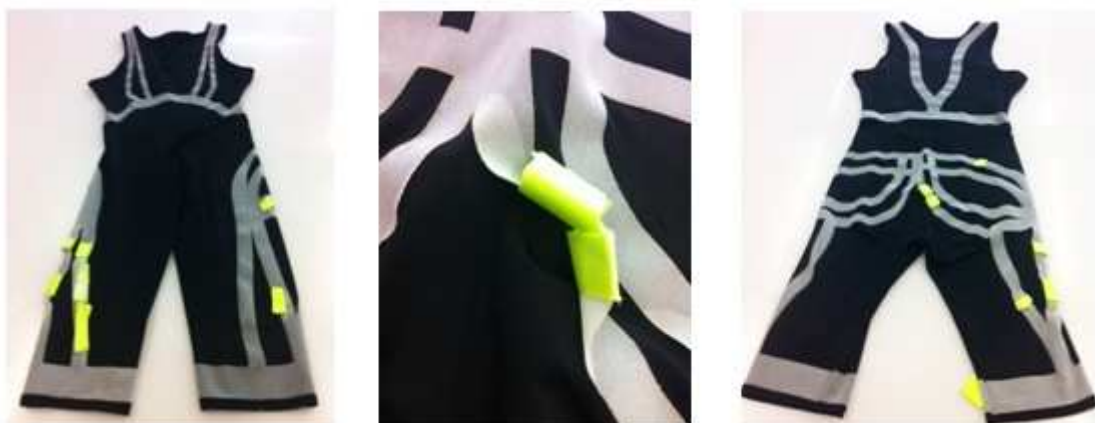
Obrázek 10: Žlutozeleně označena místa odlepení látek. [17]
