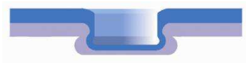
Obr. 39 Grafické znázornění řezu klinčovacího spoje [20]
