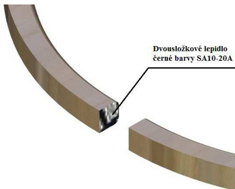
Obr. 65 Spojení vyztuhy v jeden celek pomocí lepeného spoje
