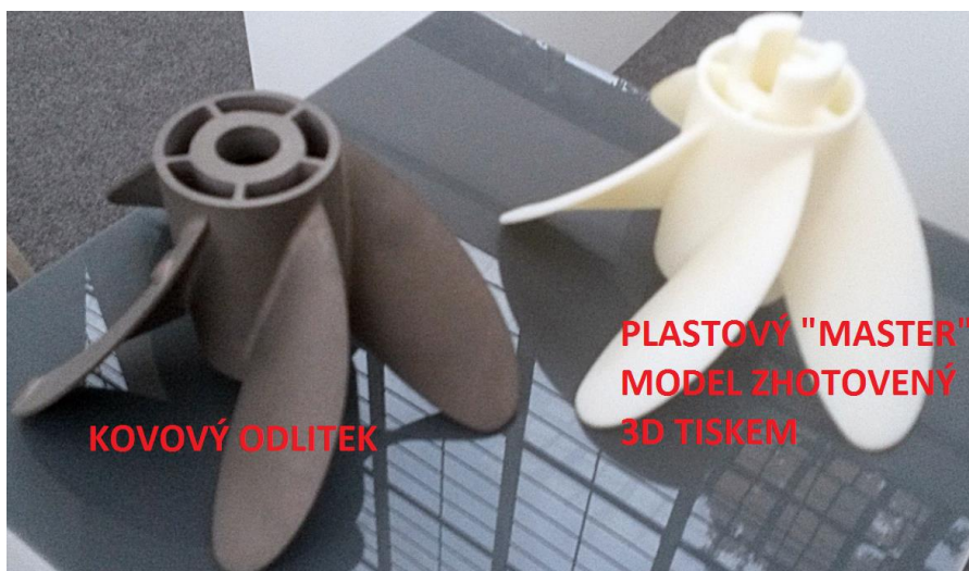
Obr. 9 Využití plastového master modelu k výrobě kovového odlitku
