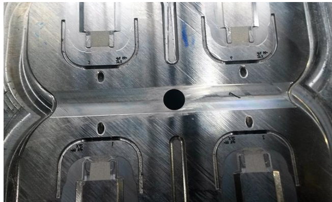
Obr. 29 TVC s tunelovými vtoky zhotovené novou technologií
