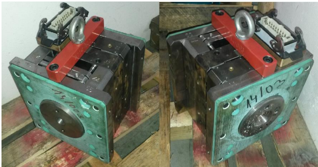
Obr. 20 Čtyřnásobné vstřikovací forma na které byla provedena racionalizace
