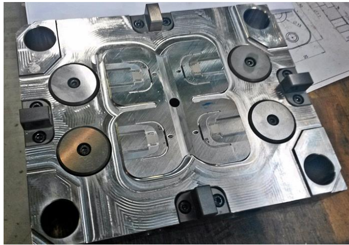
Obr. 37 Obrobená TVC s již namontovanými střediči a dosedkami
