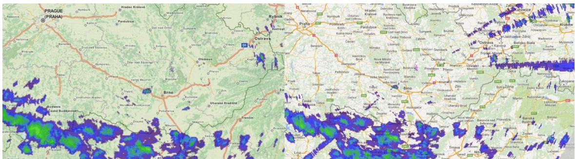
Obr. 13 Rušení meteorologického radaru Wi-Fi 5,5 GHz [42, 43]
