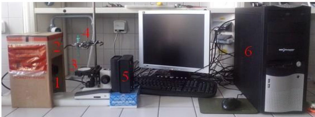
Obr. 13 – 1: vysokorychlostní kamera Basler, 2: stínění, 3: posuvný stolek se vzorkem, 4: stojan se stříkačkou, 5: zdroj světla, 6: PC s příslušenstvím
