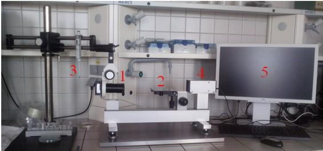
Obr. 12 – 1: kamera moticam 2300, 2: posuvný stolek na vzorek, 3: mikropipeta, 4: zdroj světla, 5: PC s příslušenstvím
