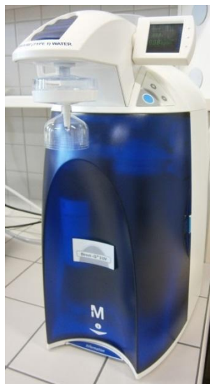
Obr. 11 – Přístroj na čištění vody
