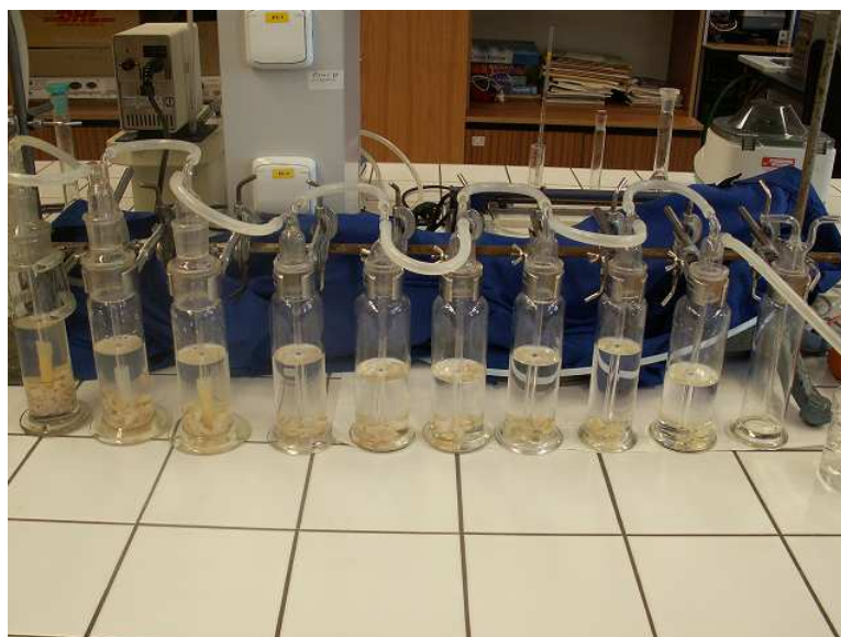
Obr. 5. Promývací aparatura se vzorky holiny.
