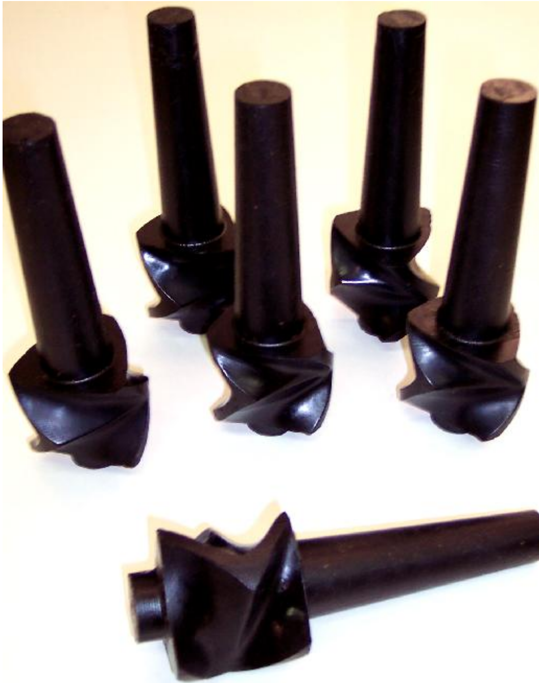
Obr. 42. Voskové modely hnětadel
