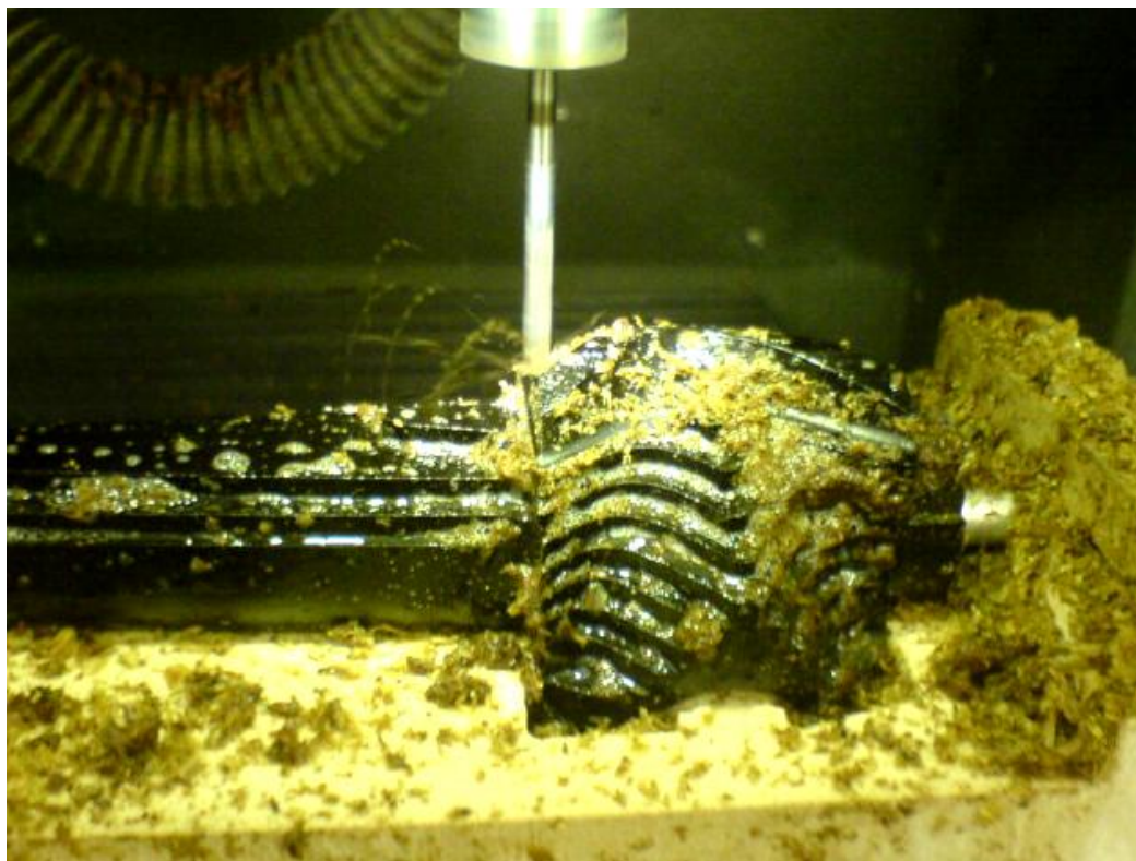
Obr. 40. Dokončovací obrábění druhé strany modelu hnětadla
