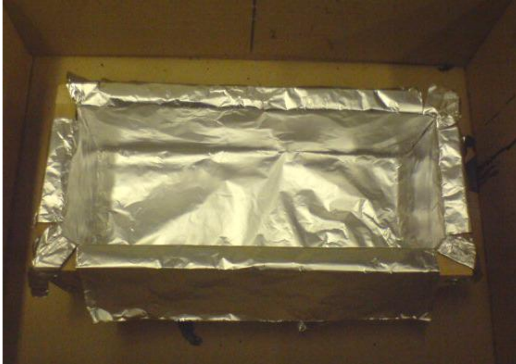
Obr. 19. Forma připravená k odlévání vosku
