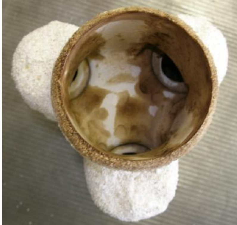
Obr. 44. Pohled do vypálené skořepiny
