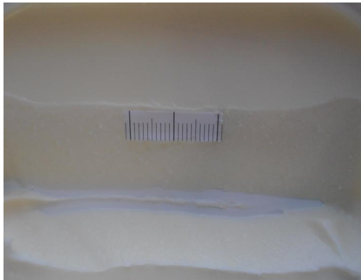
Obr. 38 Fotografie termixu s přísávkem guarové guma a tragakantu o koncentraci 0,2 % (w/w) v poměru 40:60
