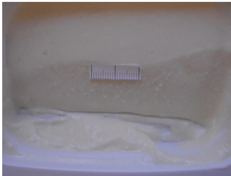
Obr. 30 Termix vyrobený s hydratovanou binární směsí guarová guma:xantanová guma v poměru 50:50 o celkové koncentraci 0,2% (w/w)
