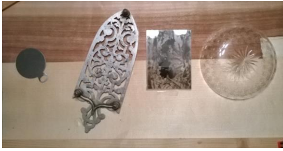
Obr. 40 – Test UV záření na dřevo
