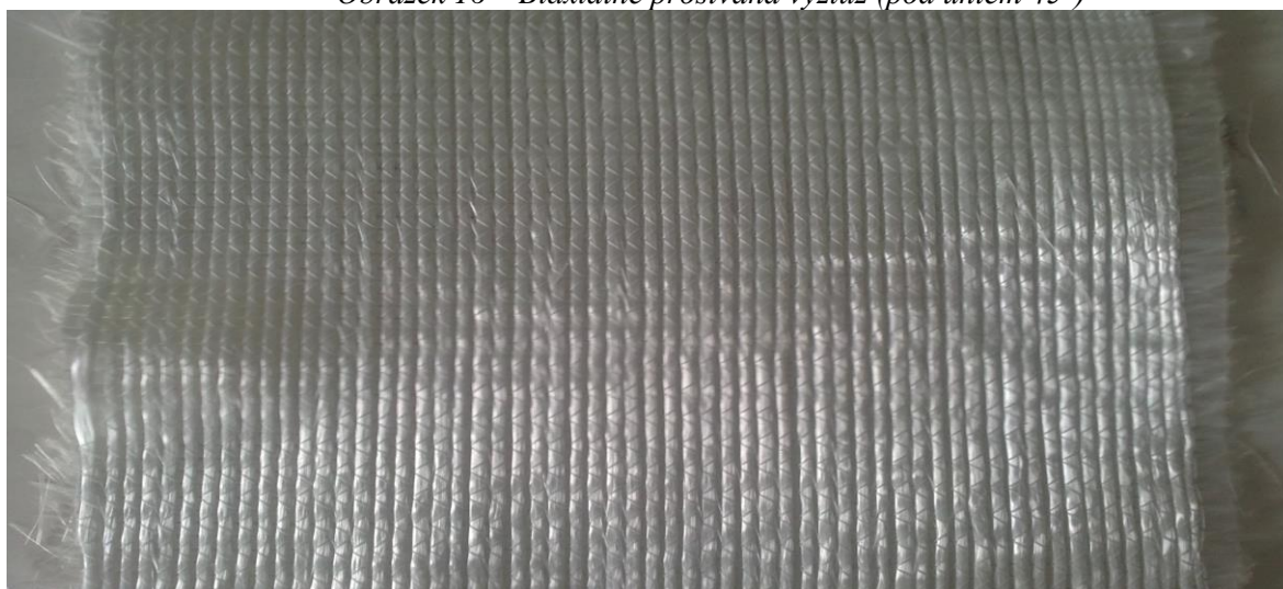
Obrázek 17 – Biaxiálně prošívaná výztuž (pod úhlem 90°)
