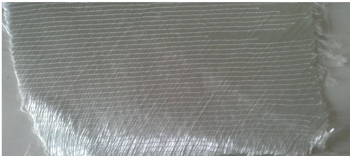
Obrázek 16 – Biaxiálně prošívaná výztuž (pod úhlem 45°)
