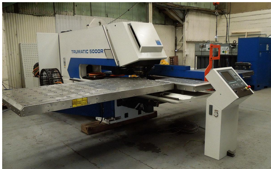
Obr. 8 Vysekávací lis (vlastné spracovanie)
