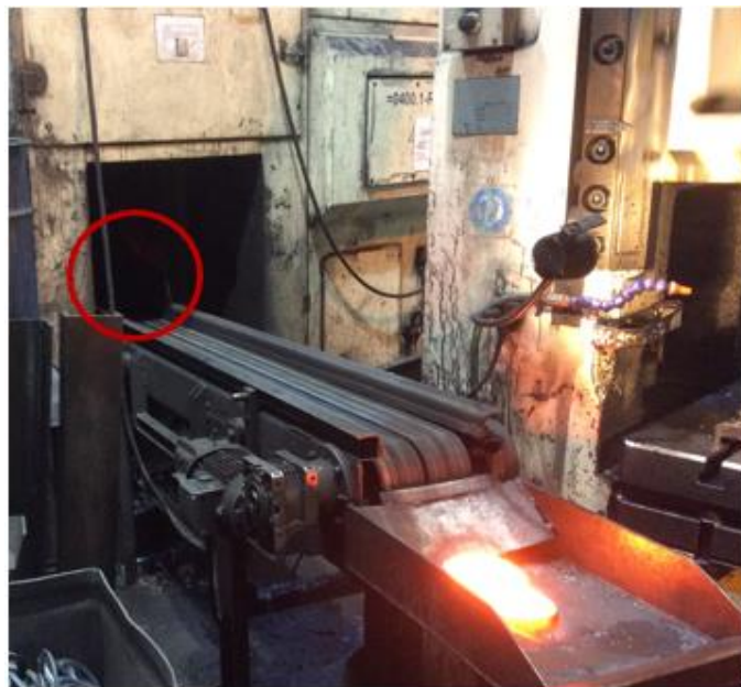
Obr. 46. Kovové zábrany proti zpadávání výkovků, vl. foto
