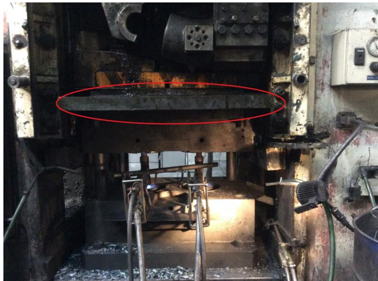
Obr. 48. Zábrany proti úkapům oleje, vl. foto.
