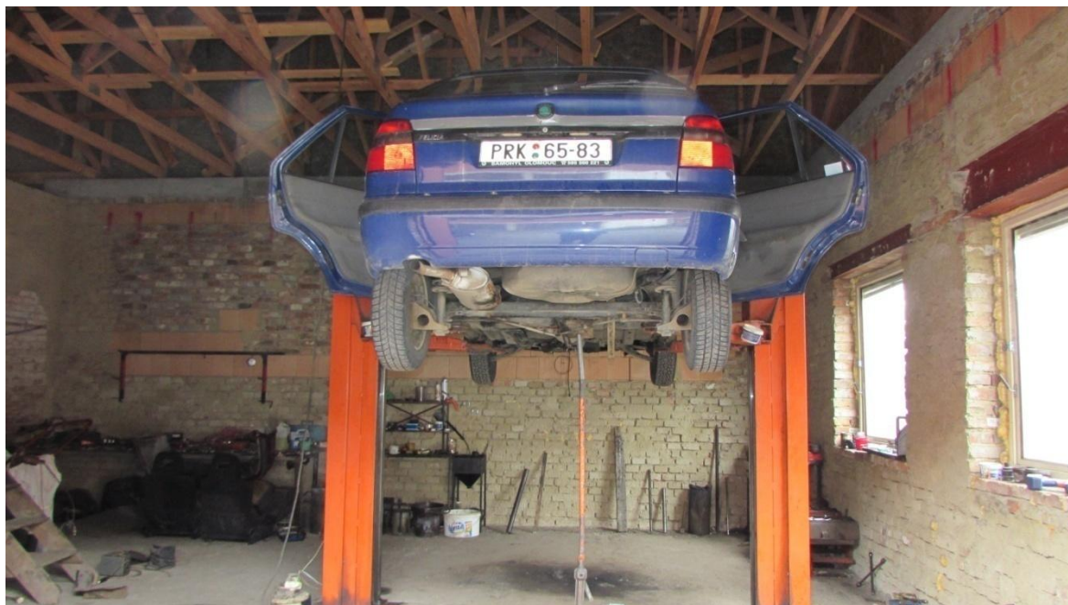
Obrázek 31 - Hydraulický zvedák určený pro autoservis
