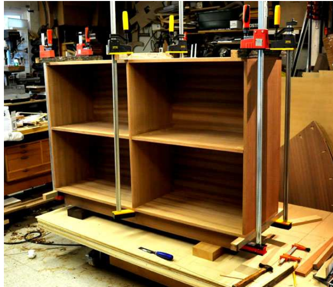
Obrázek 17: Stahování a lepení korpusu (zdroj: http://msfinewoodworking.blogspot.cz/ )
