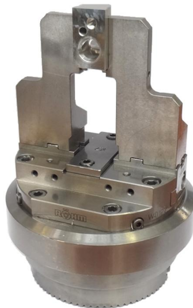
Obr. 33 Upnutí dílu v čelistech palety stroje
