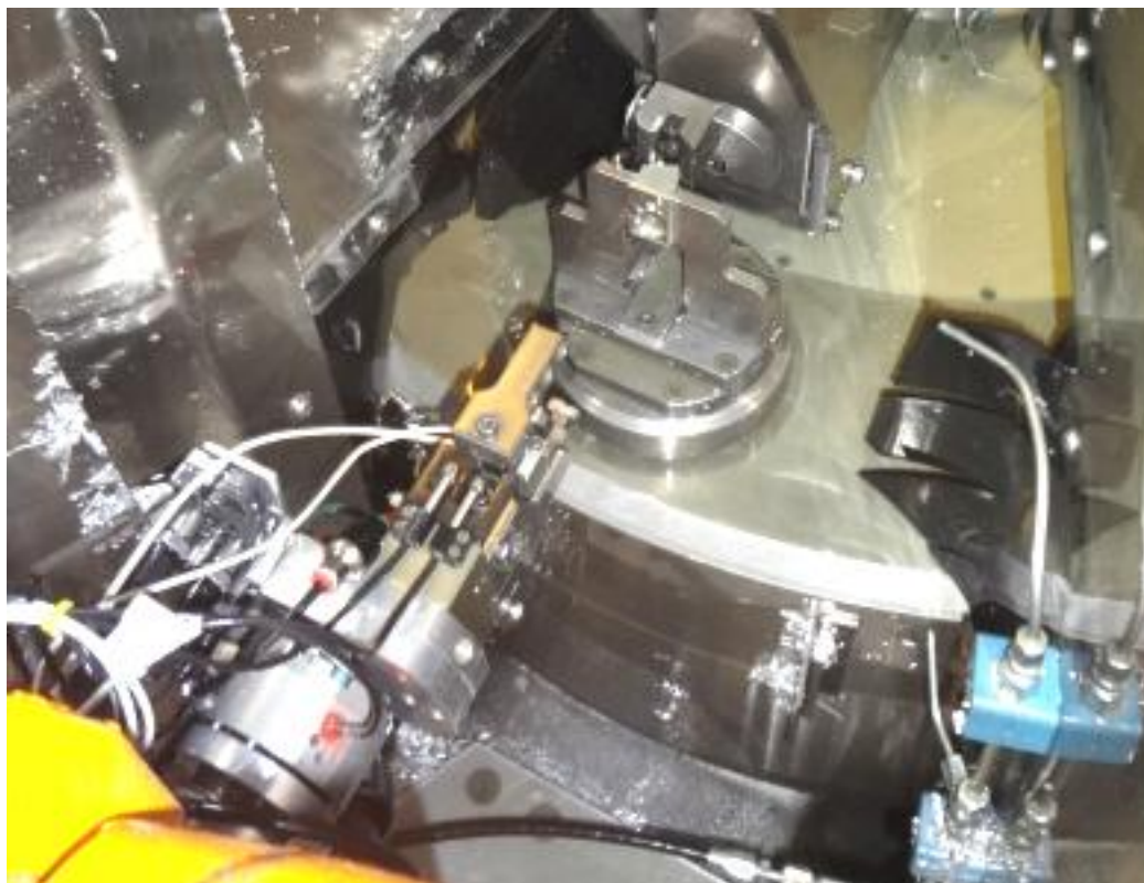
Obr. 50 Zakládání a vykládání dílu ve stanici 10 robotem Stäubli TX40
