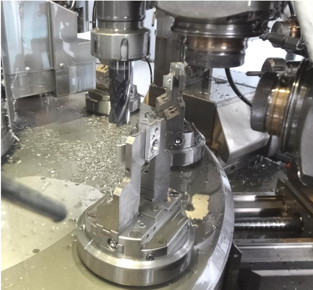
Obr. 48 Obrábění dílu ve stanici 7 nástrojem T10
