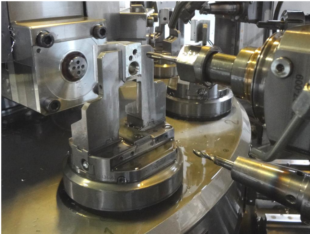
Obr. 44 Obrábění dílu ve stanici 4 nástrojem T07
