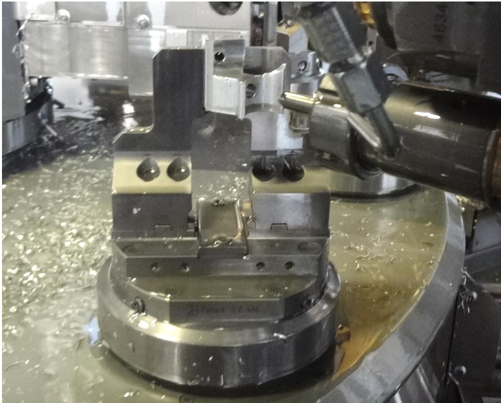
Obr. 47 Obrábění dílu ve stanici 6 nástrojem T09
