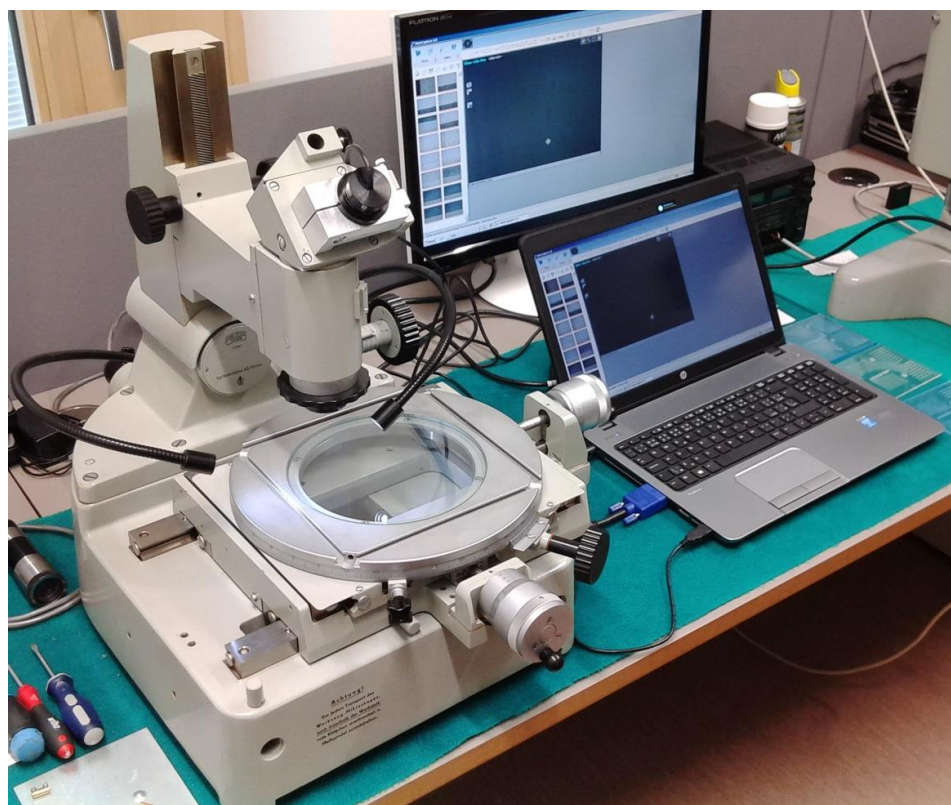
Obr. 40 Mikroskop oční digitální AM423B
