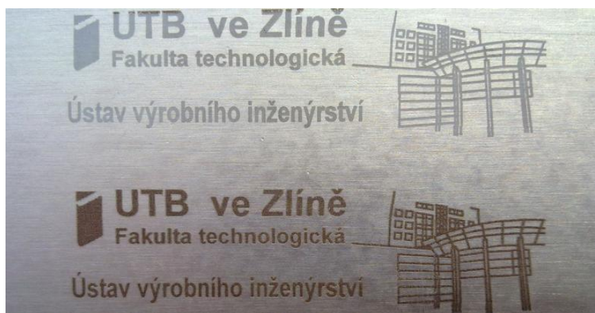
Obr. 83 Další ukázky obrábění vzorku A (vrchní obrázek - výkon/rychlost = 20/100%, spodní obrázek - 40/100%)
