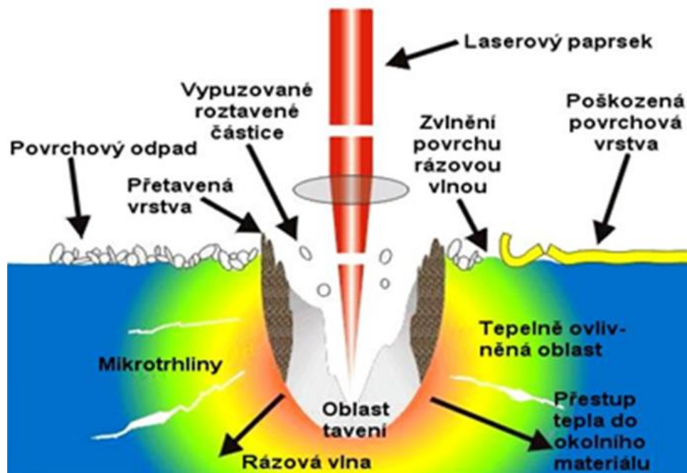
Obr. 13 Účinek laserového paprsku při dopadu na obráběný materiál [7]
