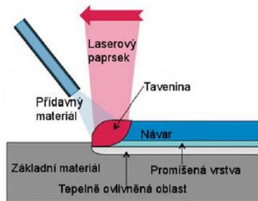
Obr. 29 Princip navařování [35]
