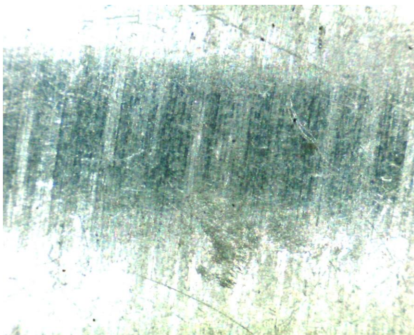
Obrázek 64 G. Al C210 s povrchovou úpravou po 100 cyklech
