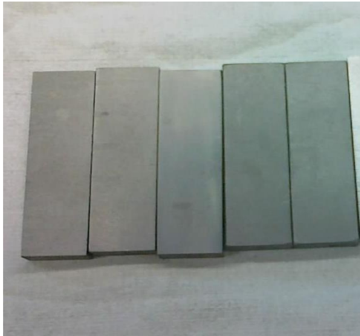
Obrázek 30 Povrchová úprava tělísek vrstvičkou CrN
