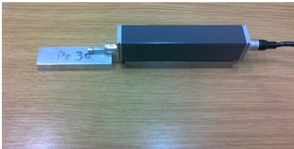
Obrázek 28 Měření drsnosti na zkušebním tělisku
