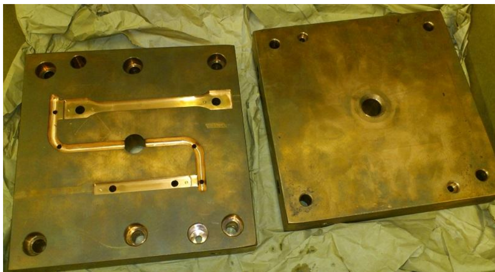
Obr. 32 Tvarové desky měděné formy
