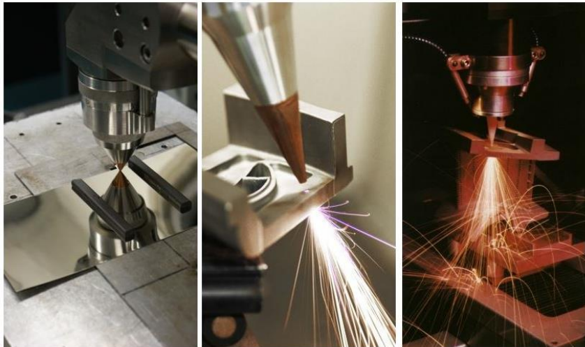
Obr. 21 – Ukázka vrtání laserem [22]
