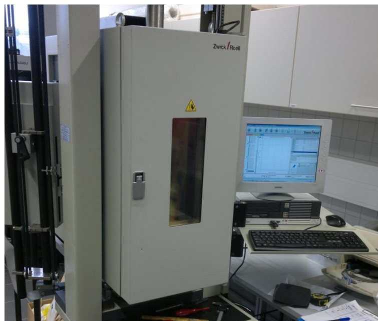
Obr. 50. Tepelná komora zkušebního zařízení
