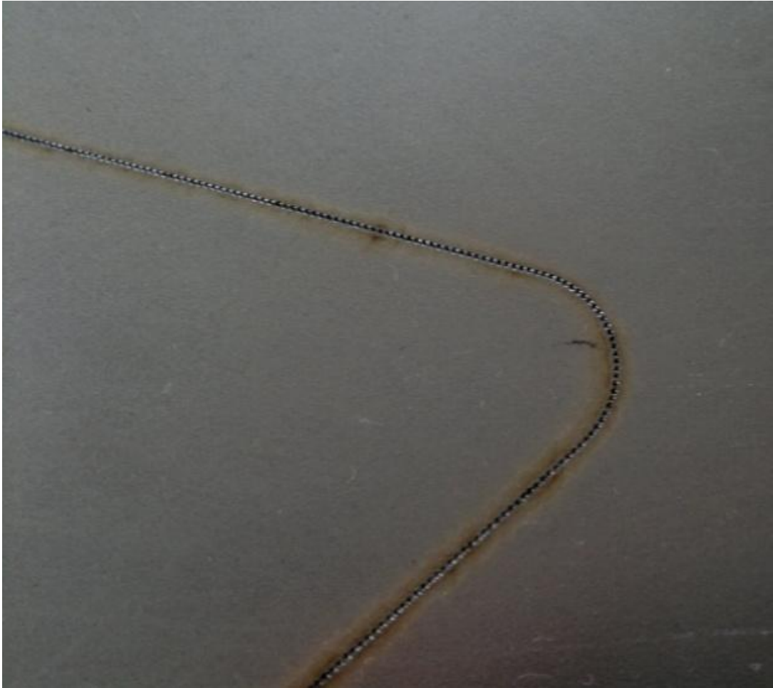
Obr. 31. Detail vytvořeného obrysu pro ořezání výrobku
