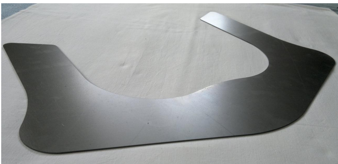
Obr. 33. Rozvinutý tvar nezvětšeného modelu
