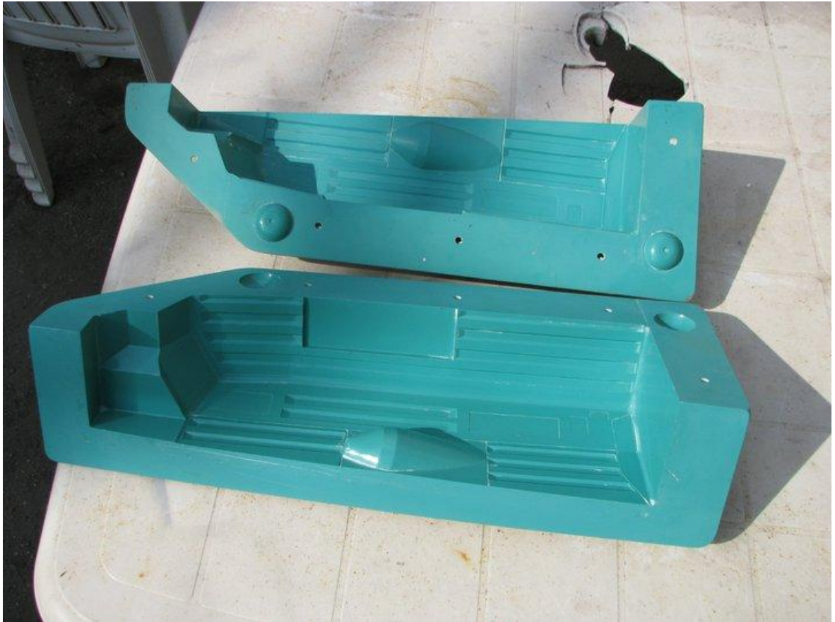
Obr. 9. Dřevěná forma určená pro výrobu součástí ze skelných vláken [8]
