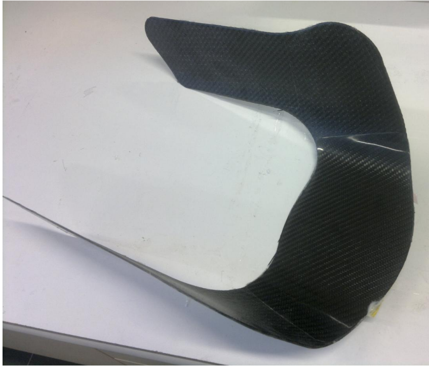
Obr. 63. Díl vyjmutý z formy
