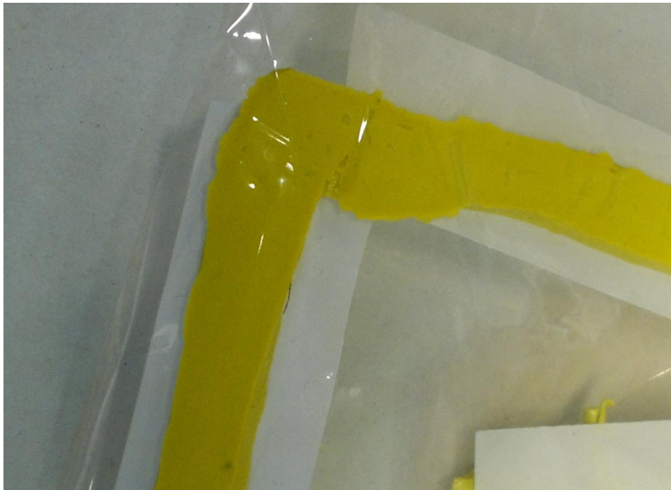
Obr. 14. Vakuová fólie s nalepenou těsnicí páskou
