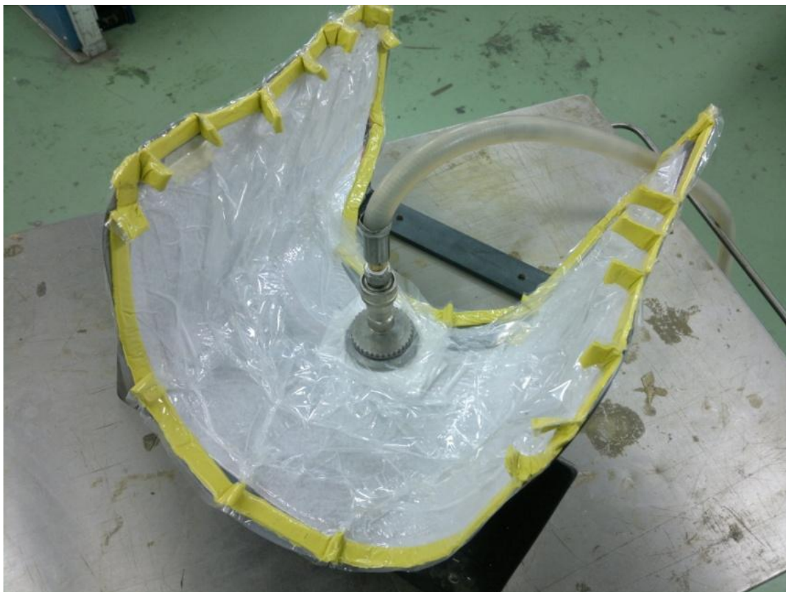
Obr. 41. Připravený a zavakuovaný materiál ve formě
