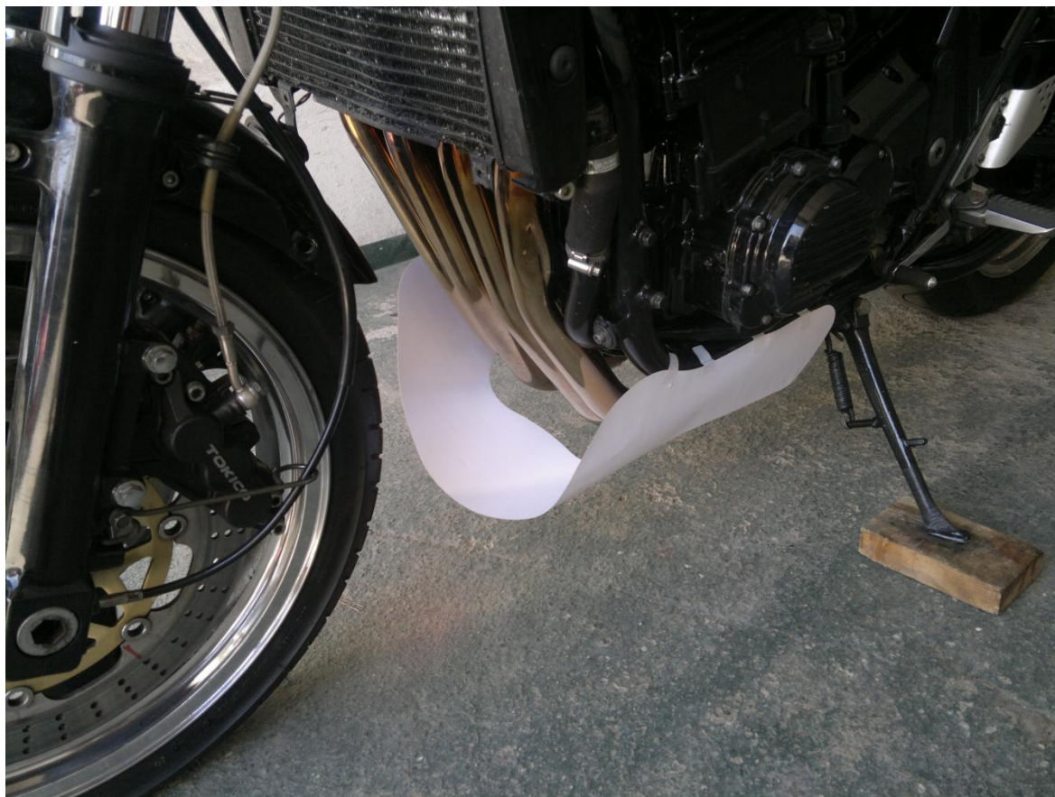
Obr. 29. Šablona připevněná na motocykl Kawasaki ZRX 1100
