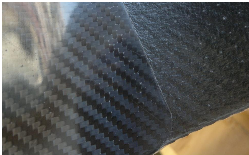
Obr. 64. Detail vytvořené pohledové plochy
