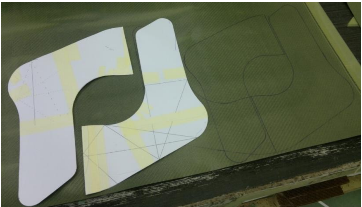
Obr. 37. Nástřihový plán využitý u ověřovací součásti
