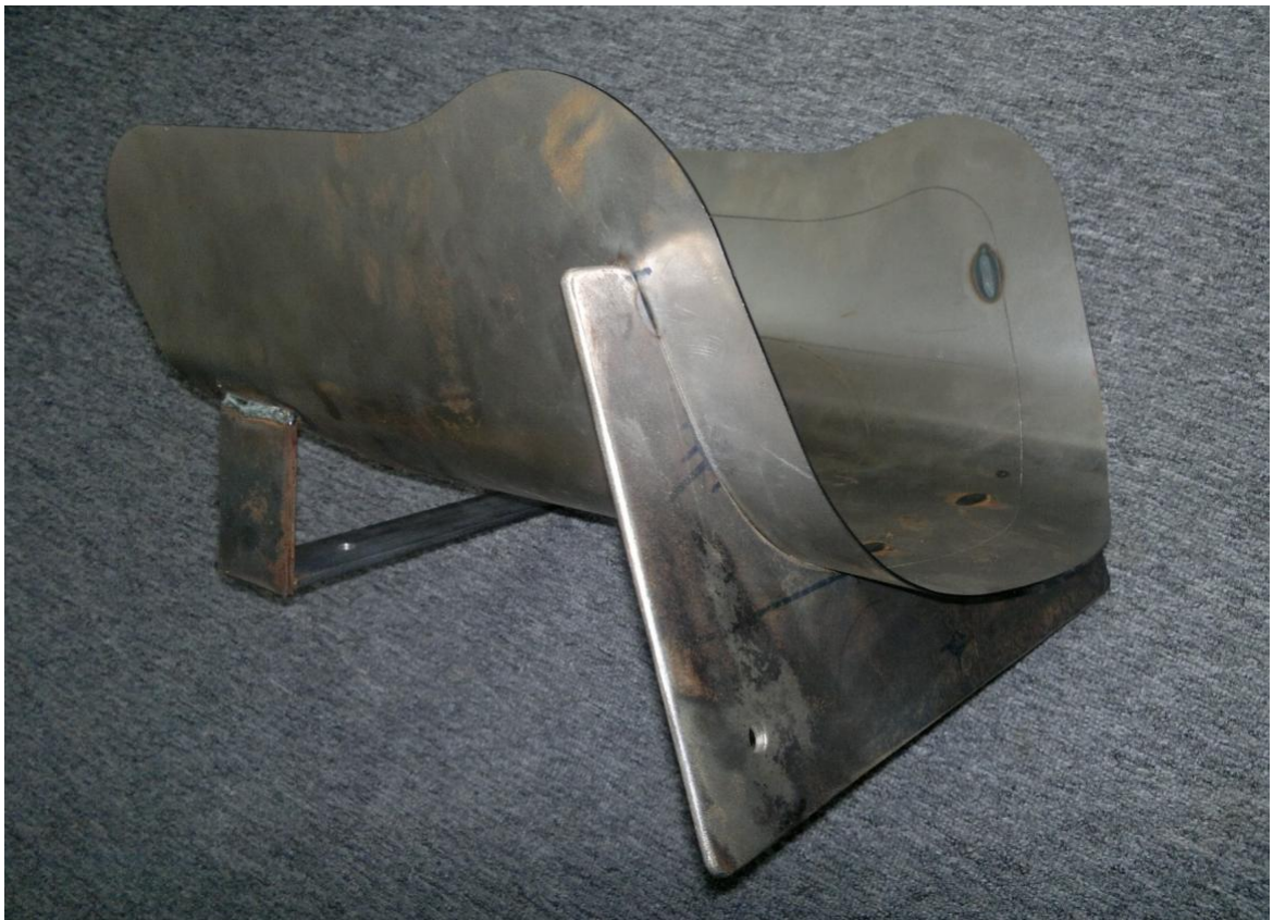
Obr. 35. Vyztužení plechového těla formy pomocí žebra
