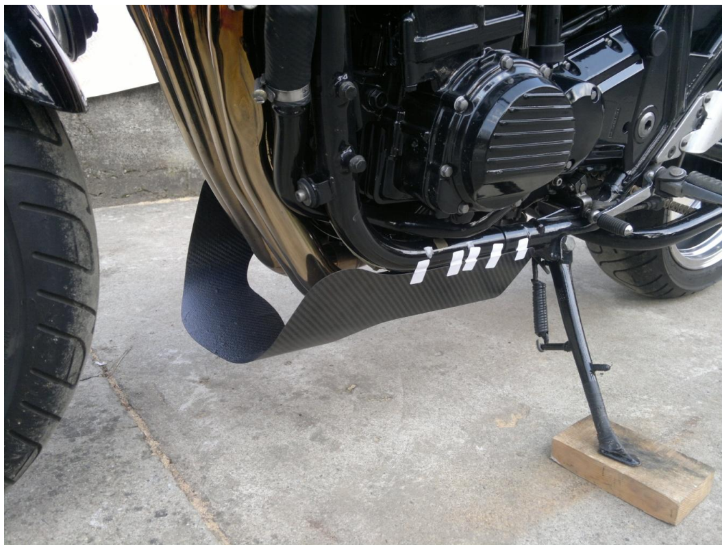
Obr. 43. Prototyp připevněný na motocykl
