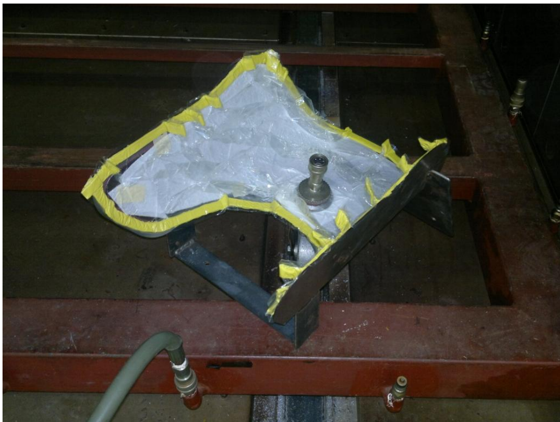
Obr. 42. Forma ve vyhříváné peci připravená na připojení hadice
