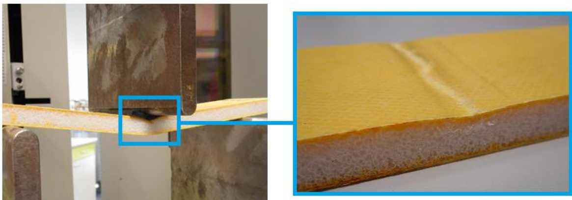
Obr. 72. Lokální porušení vnější krycí vrstvy konstrukce s pěnovým jádrem.
