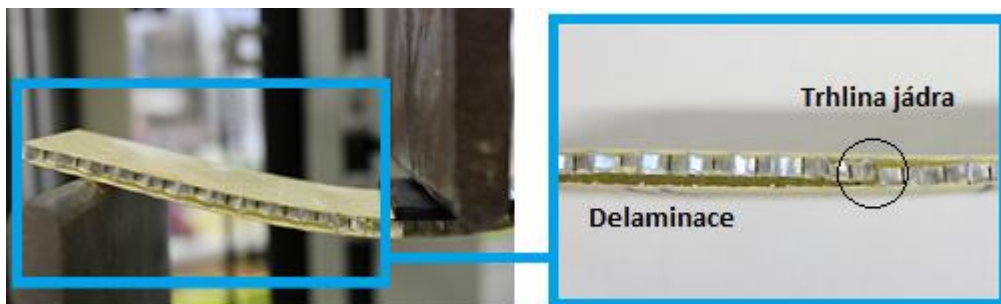
Obr. 47. Delaminace a trhlina hliníkového voštinového jádra o tloušťce 3 mm.
