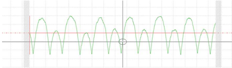
Obr. 49 Krivka profilu drsnosti na povrchu súčiastky D_25_B
