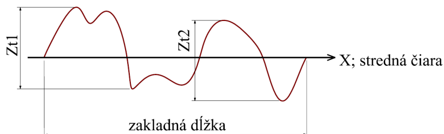
Obr. 24 Priemerná výška prvku profilu R_c [23]
