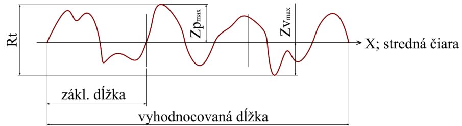
Obr. 25 Celková výška profilu R_t [25]
