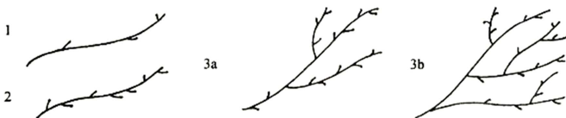
Obr. 1 Struktura makromolekul různých typů PE: 1 – HDPE, 2 – LLDPE (krátké větvení), 3 – LDPE (dlouhé a krátké větvení, a – trubkový reaktor, b – autokláv) [1]
