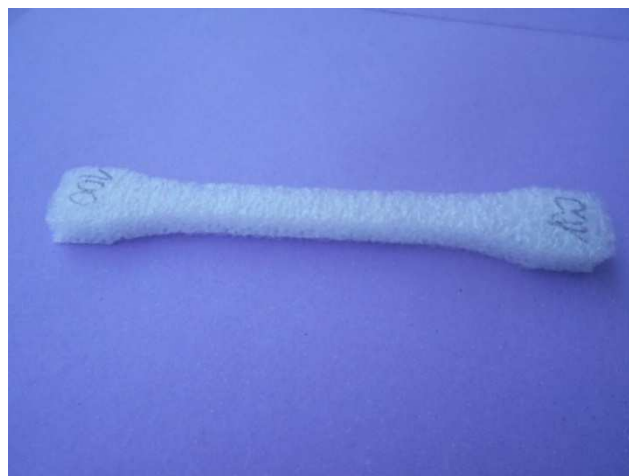
Obr. 22 Zkušební těleso pro tahovou zkoušku
