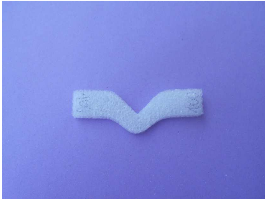
Obr. 23 Zkušební těleso pro zkoušku odolnosti proti dalšímu trhání
