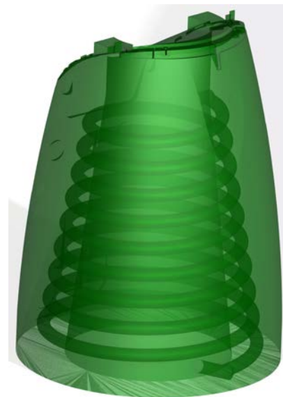
Obr. 74. Část jádra pro konformní chlazení
