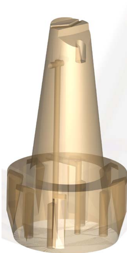
Obr. 73. Polotovár pro druhý krok výroby
