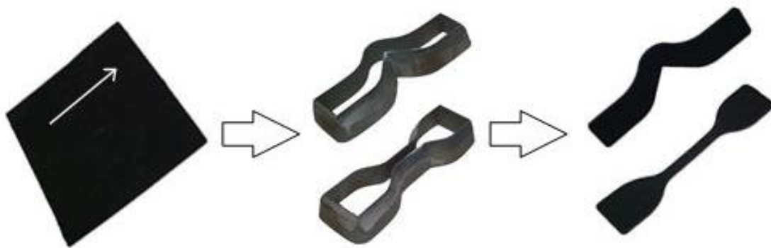
Obr. 27. Příprava těles lisováním a vysekváním
