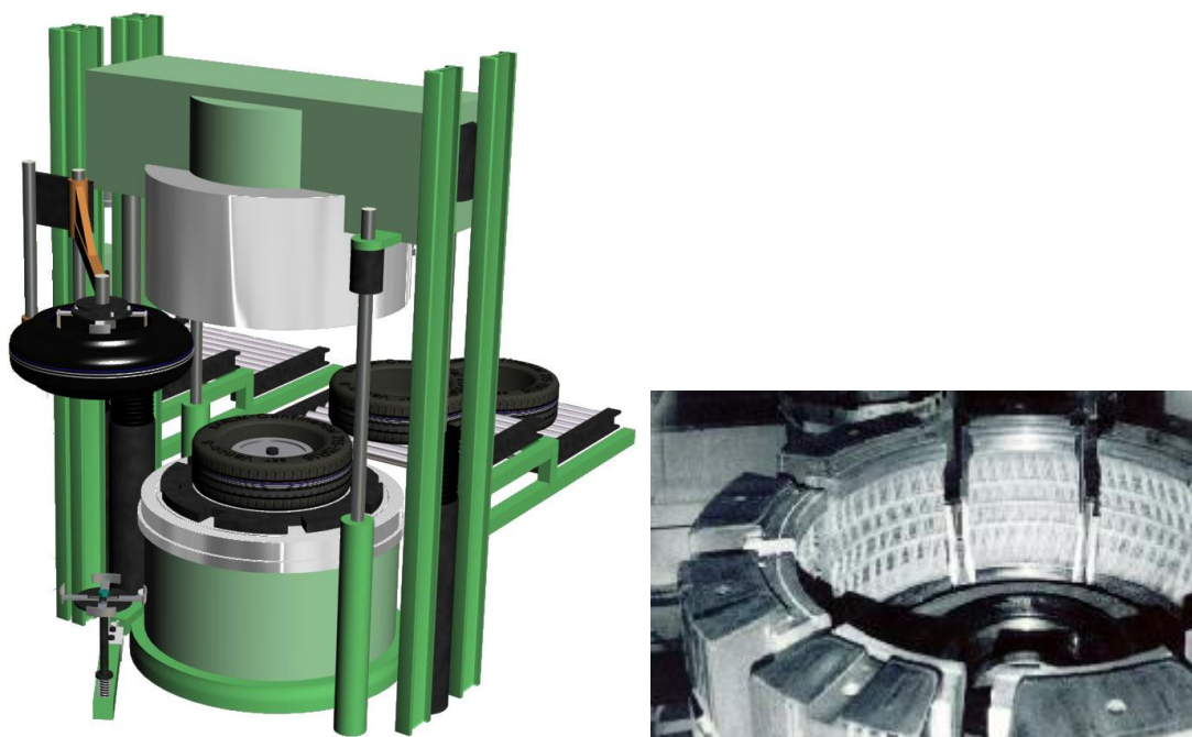
Obr. 12. Vulkanizační lis s bližším pohledem na segmenty formy vpravo [1, 23]
