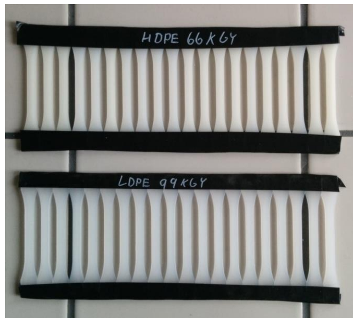
Obr. 27 Skúšobné telesá po ožiarení
