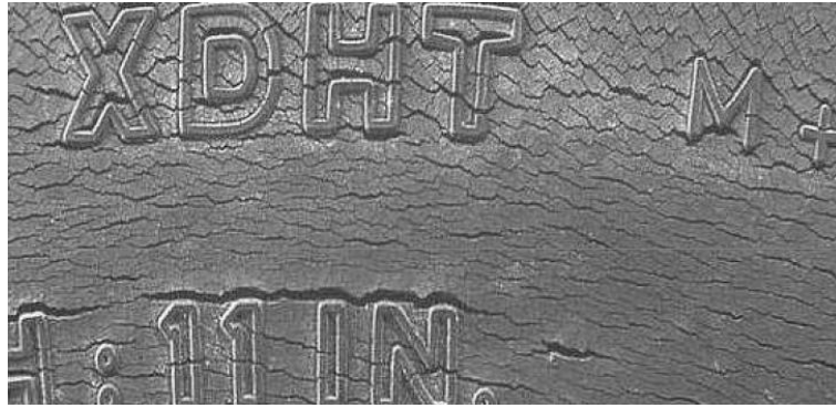
Obrázek 13 - Trhliny vzniklé dlouhodobým působením ozónu [24]
